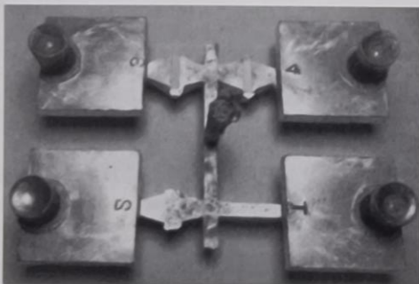
Figur 1. For å teste filterne ble det støpt fire plater fra et felles nedløp. Ved tre av platen ble det benyttet filter i innløpet, og den siste platen ble støpt uten filter. På denne måten ble alle tre filtertypene benyttet ved hvert austøp.
